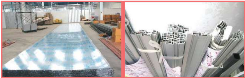
รูปที่ 2-9 แผ่นโพลีคาร์บอเนต (ด้านซ้าย) และ ชุด Aluminium Clamping ที่ใช้ยึดแผ่นโพลีคาร์บอเนตกับโครงสร้างของระบบบอบแห้ง (ด้านขวา)
